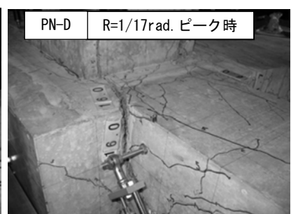
図-9 最終ひび割れ状況(上面, 下面, 側面, 背面図)
