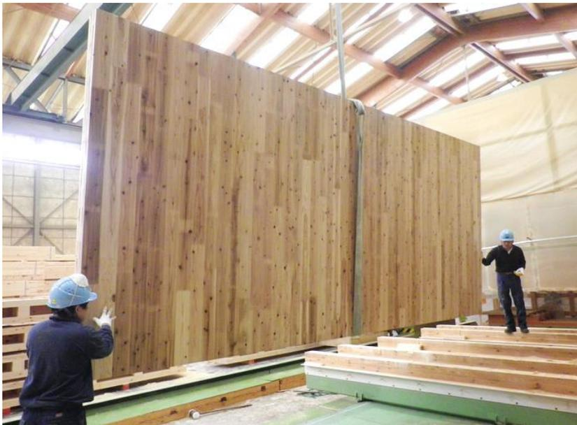
CLTパネル(写真:2.7m×6m)
