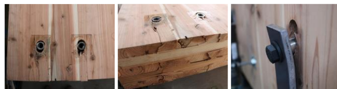
写真-1 破壊性状(左から試験体1,2,3)
