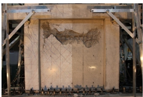
写真-4 P150 最終破壊形状
