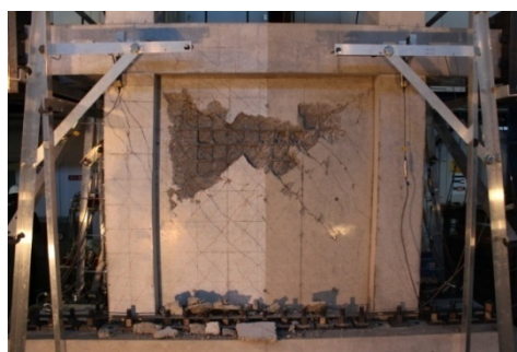
写真-3 P125 最終破壊形状
