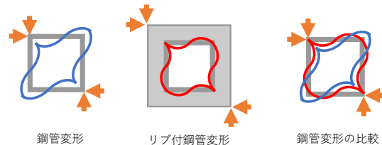
図-4 曲げ剛性を確保する機構
