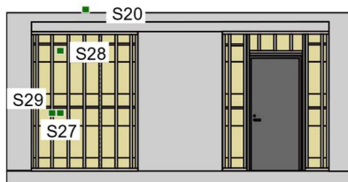
貼付先 S22:鋼製ドア, S23-26, S30, S31:上張りボード 貼付先 S27-28:下張りボード, S29:スタッド, S20:RC 梁
