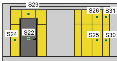
貼付先 S22:鋼製ドア, S23-26, S30, S31:上張りボード 貼付先 S27-28:下張りボード, S29:スタッド, S20:RC 梁
