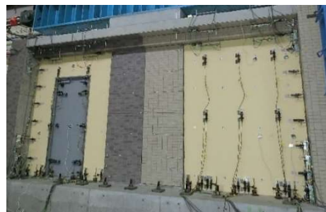
写真 1 試験体立面（上張りボード側）
